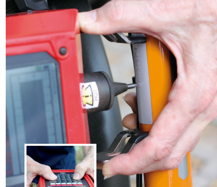
Der individuelle Code wird in das Nadelmarkiergerät eingegeben und danach elektromechanisch in das Rahmenrohr geprägt.
