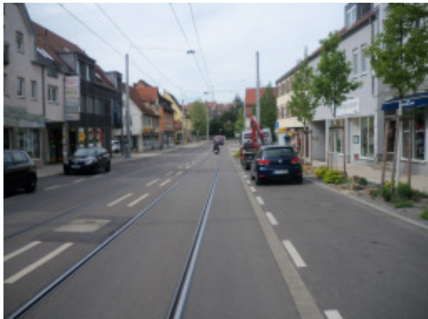
Freihofstraße: Rechts des Gleises genügt der Platz nicht, um genug Abstand zu den Autotüren zu halten
