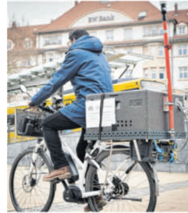
Das E-Bike dient als mobile Messstation von Luftschadstoffen. Foto: Ferdinando Iannone
