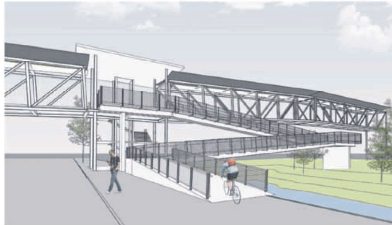
Das untere Ende der Fahrradrampe am Bahnhofsteg mündet nun parallel auf den Radweg an der Jahnstraße ein. Grafik: Büro von Bock
