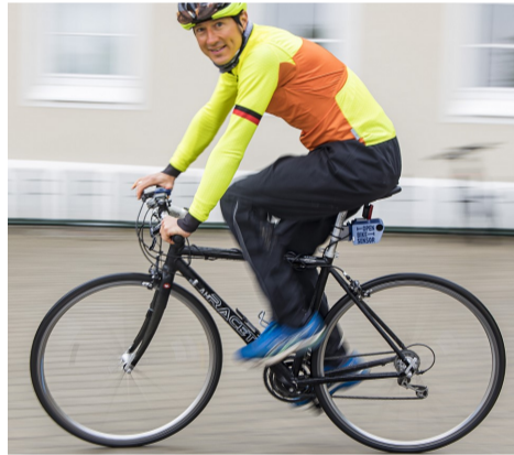
Abstandsmessung mit dem OpenBike-Sensor (unter dem Sattel). (ml)
